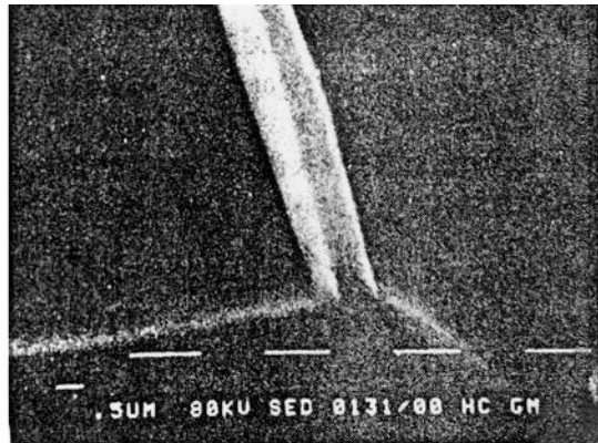
图 7 在非晶 Bi 系超导材料基体上生长出的超导晶须形貌
