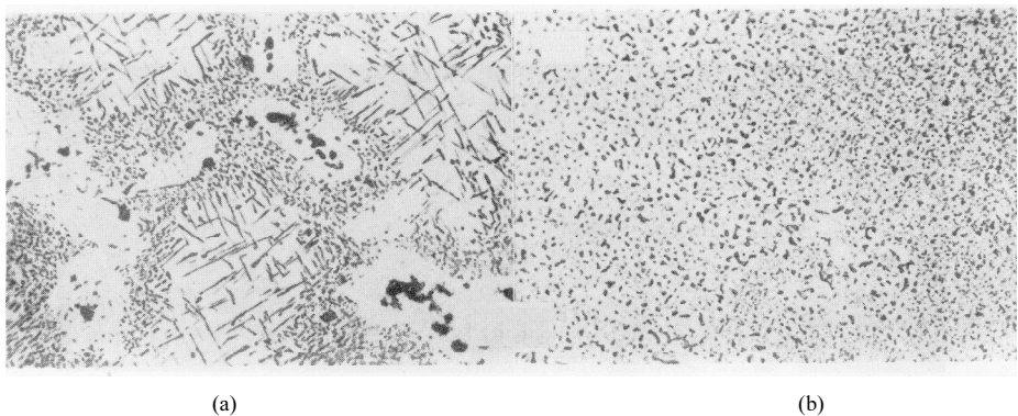
图 16 激光熔凝对 \sigma 相的影响
